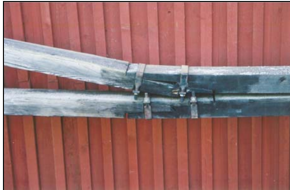
Figur 14. Brott på nordöstra vevaxelarmen
