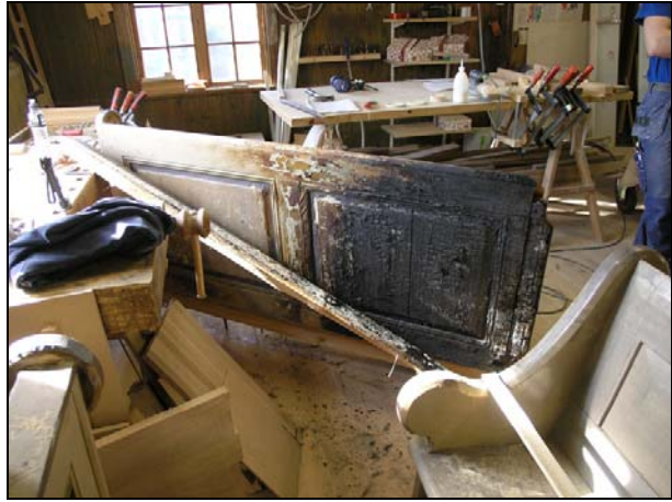
Figur 81. Bränd baksida på bänk samt utbytt psalmboksbräda och fot.
