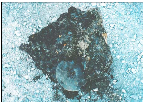
Figur 7. Fynd från nedre delen av bärlagret bestående av en slaggklump med slipskiva. (Foto U. Alström.)
