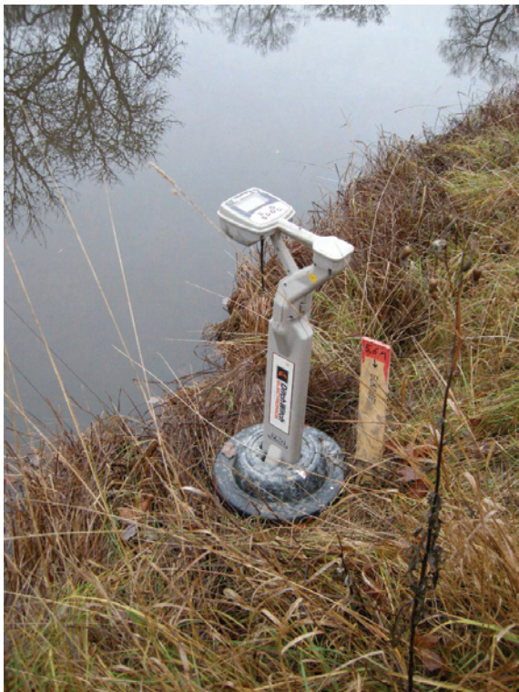
Bild 6. Vid kanalens västra strandkant var rörens djup 5,6 m. På bilden syns mätinstrument. Foto: Boel Melin.
