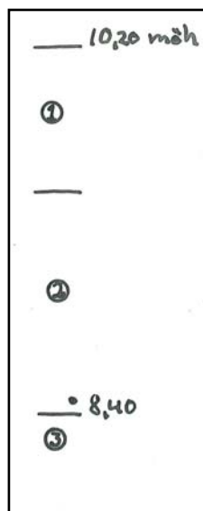
Figur 3. Borrhplats 2 i området Sturestaden 3:1 ligger i östra delen av borrhområdet. Lager 1 bestod av utfyllnad med inslag av asfalt. Lager 2 innehöll mörk kulturjord med flis. Vid punktmarkeringen togs 1 bit läderspill för ^{14}\text{C} datering. Lager 3 är ren blålera. (Profil från skruvborren skala 1:40.)
