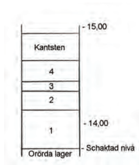
Figur 7a. Sektion 1 sedd från söder. Lager 1 var kyrkogårdsjord med inslag av tegel. Vidare ses lager 2 som antas vara raseringsmassor från det Rudbeckianska gymnasiet. Lager 3 och 4 var bärlager. Ursprunglig marknivå nåddes inte. Skala 1:40. Ritning: Jonas Ros.
