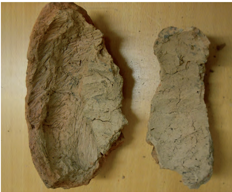
Figur 3. Bild av insidan av innerformsfragment av typ 1. På delen till vänster ses avtrycken efter en halmkärna, som måste ha avlägsnats innan lerlagret till höger smetades på. Därefter har formen bränts.
