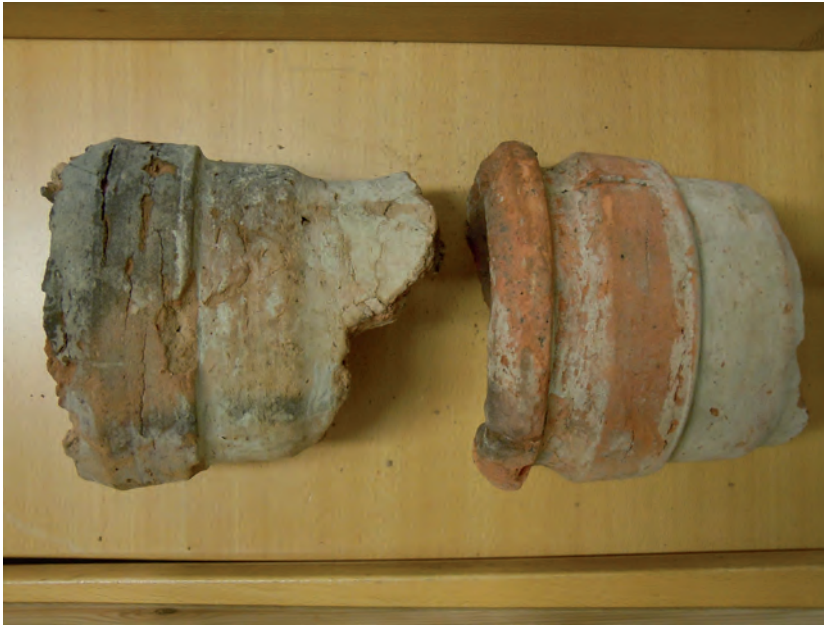
Figur 5. Bild på två fragment av den övre, halsformade, delen av innergjutformar av typ 1. Vulster och fårör på den överste delen av dessa fragment utgör ett låssystem mellan denna del (innerform) och en ytterform (som det inte har hittats några rester efter).
