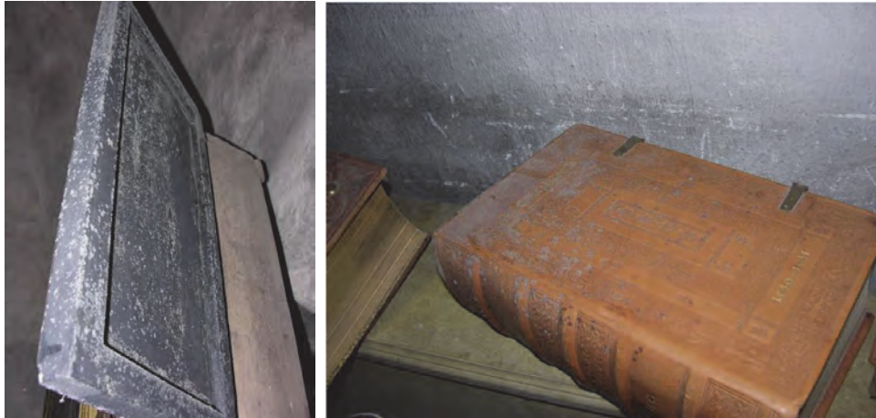
Figur 12. Altarskåpets baksida med mögelangrepp. Foto: Svensk Klimatstyrning.
