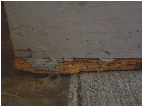
Figur 86. Bottnen på träkåstan hade kraftiga insektsangrepp. Foto: Helén Sjökvist.
