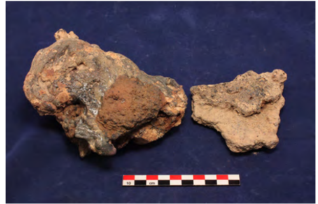
Fig. 29. Slagg med fastmält infodring (vänster). Infodring där det hårdbrända skiktet delvis släppt. Foto: GAL.
