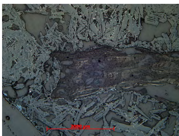
Fig. 4. Foto från mikroskopet på slagg nr 5. Mitt i bilden finns ett inneslutet kolstycke, kantat av en tunn ljus strimma (se nästa figur).
