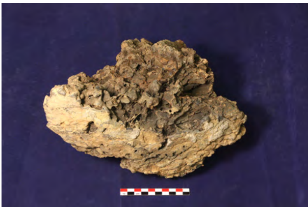
Fig. 25. Den näst största delen av bottenlaggen. Vänstra bilden visar hur olika slagglöden samlats och stelnat mot slagguppsamlingsgropens vägg. Högra bilden, tagen rakt uppifrån, visar hur kurvaturen på slagguppsamlingsgropens vägg planar ut åt vänster. Foto: GAL.
