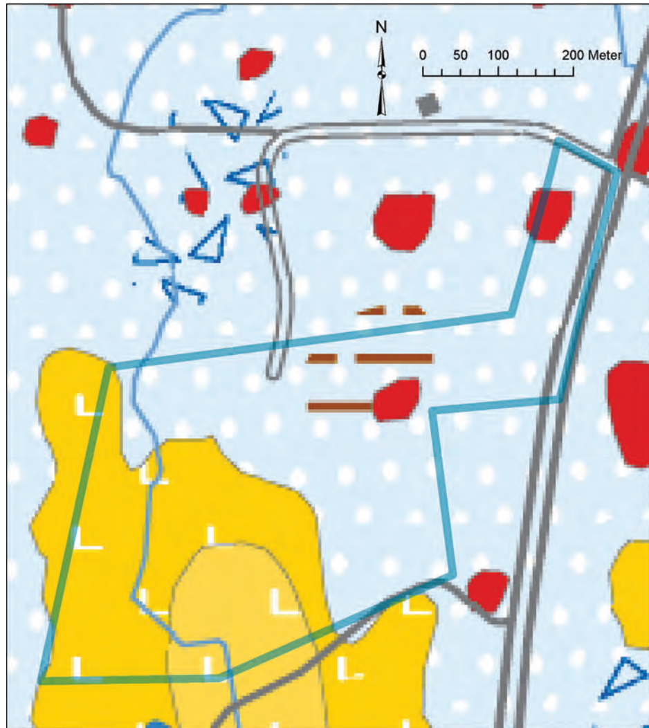
Fig. 3. Utdrag ur SGU:s digitala jordartskarta. Utredningsområdet är markerat med en blå begränsningslinje. De ljusblå områdena, med vita prickar, utgörs av moränmark med inslag av kalberg eller yttligt beläget berg (röda fält). Området med en intensivare gul färgton utgörs av glaciallera. Partiet i söder, med den ljusare gula färgtonen, består av postglacial lera. Skala 1:7000.
