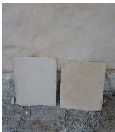
Figur 13 & 14. Uppstrykningsprover mot avfärgad fasad med fyra strykningar. Den högra skivan har färgnyansen med 200 gram guldocke. Skillnaden mot fasad är tydlig, resultatet är blekare än beräknat. Bilden till höger visar fasaden efter femte strykningen då ytterligare 25 gram guldocke användes per 25 kg kalkpasta. Foto: Tobias Mårud.
