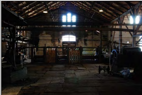
Sydöstra väggen, med valsverket, hängverket och röret från blåsmaskinerna framför.
