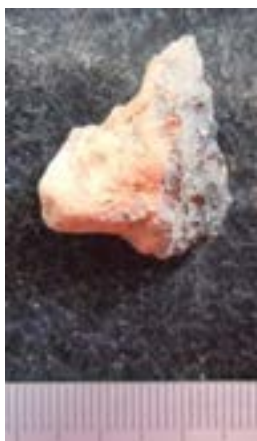
Fig. 3. Prov E från A411. Litet fragment med svart glas-zon och i övrigt oxiderad – möjligt ässjefodringsfragment.
