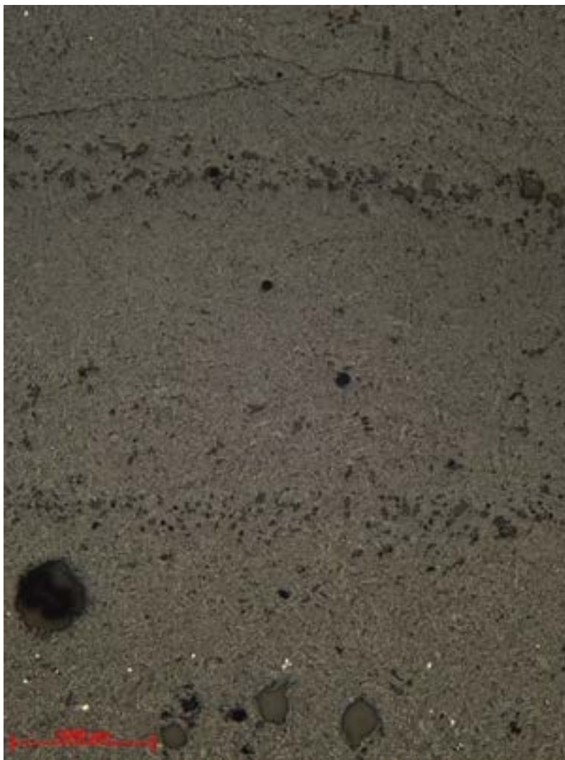
Figur 20. I slaggen V914 ses flera pålagrade slagglöden nerifrån och upp. De kan främst urskiljas med hjälp av ansamling av porer längs kontaktytorna. I alla flöden ses olivinkristaller (ljus grå), en mörkare grå glasfas samt ljusare wüstit och några enstaka vita droppar av metalliskt järn.
