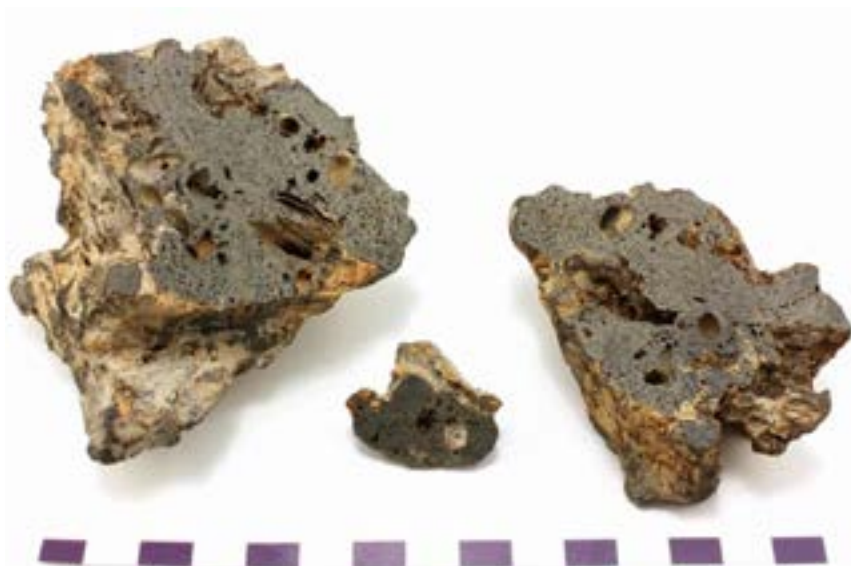
Figur 4. Prov V378, från A378, efter sågning. I snittytan på den trögflutna slaggen ses en del större och många mindre porer. Biten i mitten har preparerats till tunnslip för petrografisk analys i mikroskop.
