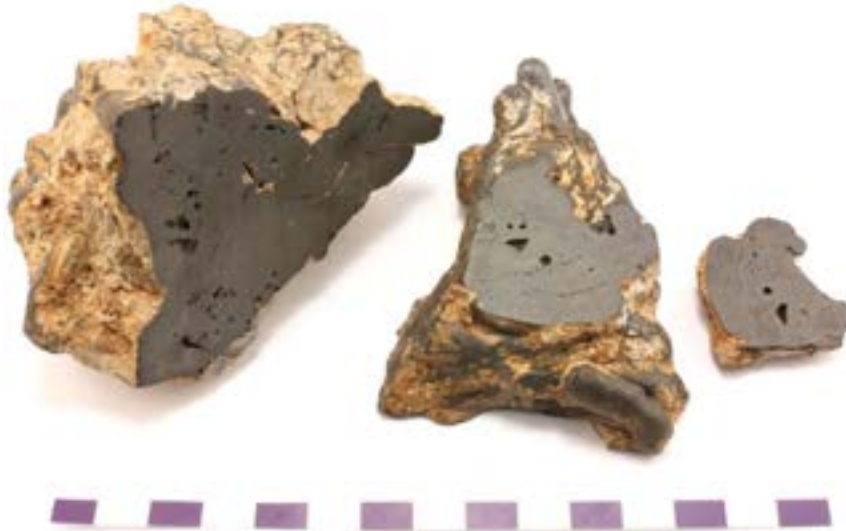
Figur 9. Prov V914, från A914, efter sågning. I snittytan ses att de små slagglöden som ses i ytterkanten har byggt upp en större, mestadels tät, slagg. Den högra biten har preparerats till tunnslip för petrografisk analys i mikroskop.
