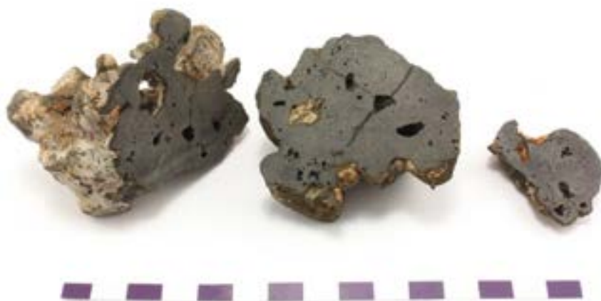
Figur 2. Prov V284, från A284, efter sågning. I snittytan ses att de små slaggflöden som finns i ytterkanten har byggt upp en större slagg med en del större porer. Den högra biten har preparerats till tunnslip för petrografisk analys i mikroskop.
