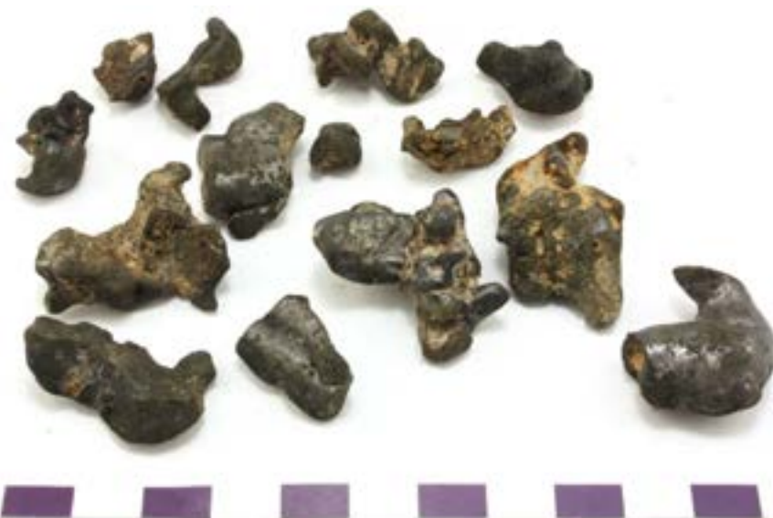
Figur 7. Slagg från A824. Dessa mindre bitar utgörs av enstaka, eller ett fåtal, tunna slaggsträngar som inte format någon större bottenslagg, men ändå är typiska reduktionsslagger.
