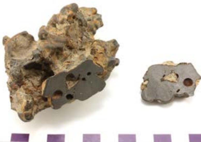
Figur 6. Prov V411, från A411, efter sågning. I snittytan kan kontakten mellan flera mindre slaggflöden anses liksom ett fåtal större porer. Biten till höger har preparerats till tunnslip för petrografisk analys i mikroskop.
