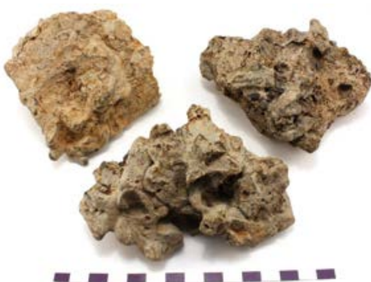
Figur 8. Slagg från A914. Trögflutna reduktionsslagger. Slaggen i mitten är tydligt uppbyggd av flera mindre slaggflöden. Denna har valts för analys.
