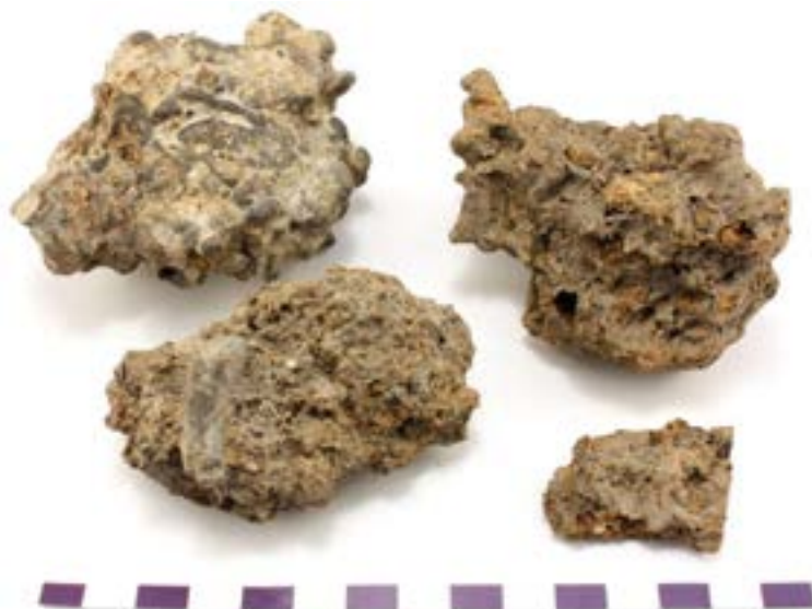
Figur 5. Slagg från A411. Trögflutna reduktionsslagger. Slaggen i övre vänstra hörnet är tydligt uppbyggd av flera mindre slaggflöden. Denna har valts för analys.
