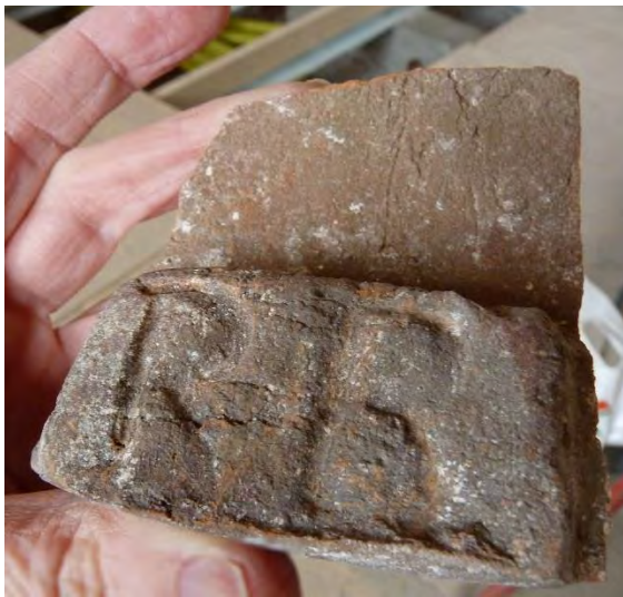
Figur 180. Fragment av taktegel, stämplat R.B, återfunnet i trossbotten. Stämpeln står troligen för Ragnhildsborgs tegelbruk i Västertälje socken.
