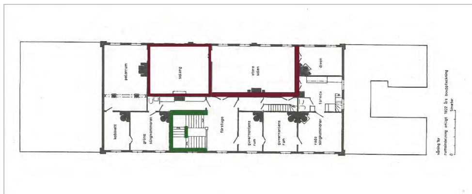
Figur 2. Röd markering visar de delar där bröstningspanelen åtgärdats 2018. Grön markering visar påbörjat arbete med golvlister. Grundritning Nordiska museet. Illustration: Helén Sjökvist.
