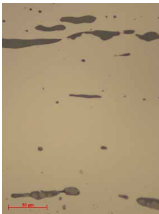
Figur 10. Amuletring F 256, prov 2. Foto från mikroskopet. Detalj som visar slagginneslutningar med två olika sammansättningar. I det övre bandet dominerar en glasfas (mörk); i det undre är slaggen wüstitrik (ljusare).
