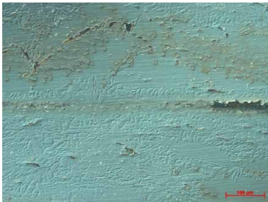
Figur 5. Amuletring F 215, prov 1. Foto från mikroskopet. Etsat prov. Detalj, med belysning från sidan som ger en topografisk effekt på grund av ett fosforinnehåll. Mitt i bilden ses en vällfog, med slagginneslutning längst till höger.
