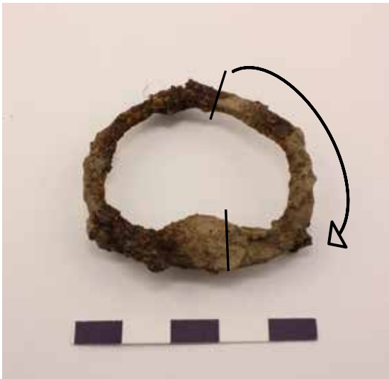
Figur 6. Amuletring F 256. Linjerna visar de provtagna områdena för metallografisk analys (prov 1 i övre delen) och (prov 2 i nedre delen). Området däremellan valdes för datering.
