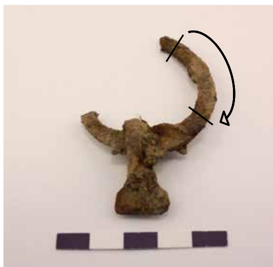
Figur 12. Amuletring F 257. Linjerna visar de provtagna områdena för metallografisk analys (prov 1 i övre delen) och (prov 2 i nedre delen). Området däremellan valdes för datering.
