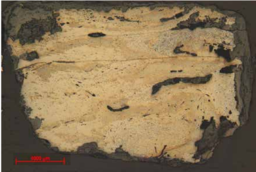
Figur 2. Amuletring F 215, prov 1, etsat prov. Foto från mikroskopet. Större grå fläckar, även längs ytterkanten är rost. De mindre grå prickarna mer centralt är slagginneslutningar som finns koncentrerade i flera stråk som löper längs med snittets långsida, eller längs dess diagonal. Metallen visar varierande kolhalt, längs samma riktning som slaggen. Det mesta utgörs av ferrit (kolfritt) i ljusa och ljus bruna nyanser. En flik med huvudsakligen perlit (kolhaltig) ses i den övre högra delen som blå-bruna korn. Jämför figur 3 från prov 2.
