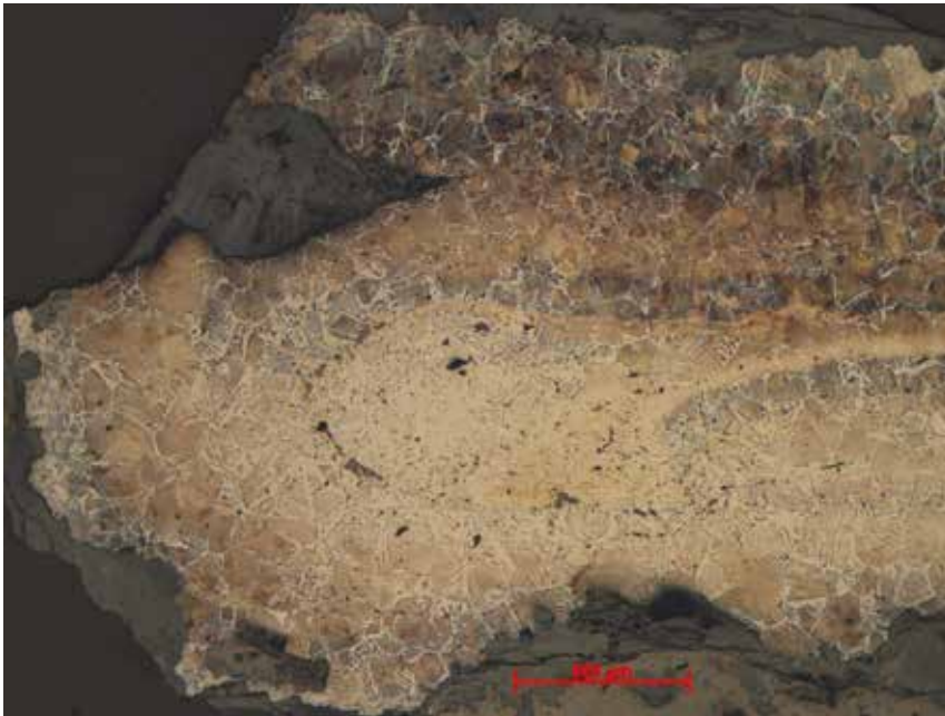
Figur 15. Amuletring F 257, prov 2. Foto från mikroskopet. Detalj ur föregående figur över området med den omböjda formen. Kontakten mellan det perlitrikare (blåbruna) och ferritrikare (ljusa) området kantas av grå slagg (wüstitrik).
