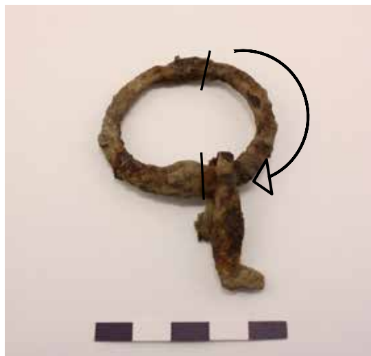
Figur 1. Amuletring F 215. Linjerna visar de provtagna områdena för metallografisk analys (prov 1 i övre delen) och (prov 2 i nedre delen). Området däremellan valdes för datering.
