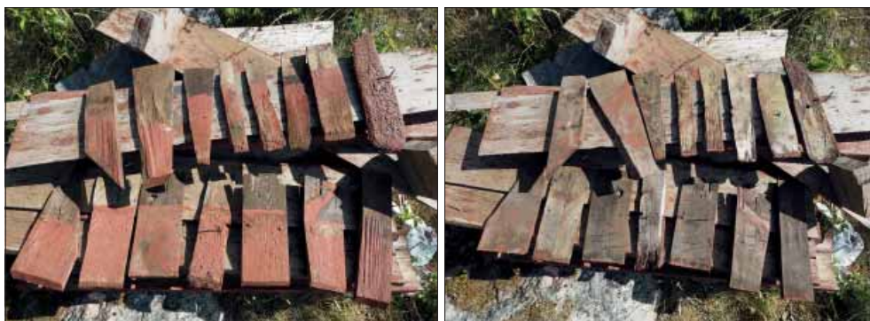
Mörkö klockstapel. Lösa spån intill klockstapeln, ovansidor (t.v.) och baksidor (t.h.). Varierande åldrar, mått, former, bearbetning och träslag.
