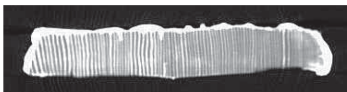
Figur 59. Tvärsnitt från skiktröntgen av Leksandsspånet. I bilden syns hela spånet i genomskärning, det vill säga om ett invändigt rötangrepp hade funnits någonstans längs med spånet så skulle det synas i bilden. I det ljusare partiet till vänster i bild syns att sommarveden haft en kraftig tillväxt. I röntgenbilden synliggjordes bland annat ytbehandlings tjocklek och inträngningsförmåga, att någon nedbrytning av skador i virket inte förekom samt att densiteten i virket är hög.
