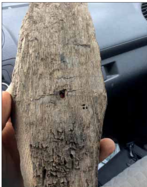
Bärbo klockstapel. Detalj från baksida av spån. Eventuellt finns en rits för att visa var infästningen ska vara eller för att markera näbbens början.
