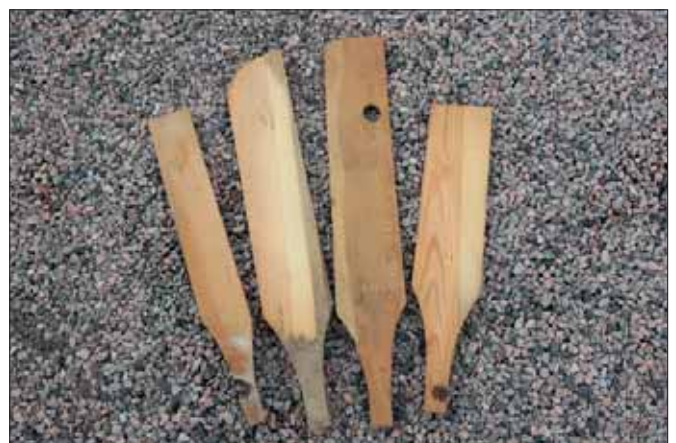
Lagningspån undersida Foto: Lisa Skanser.
