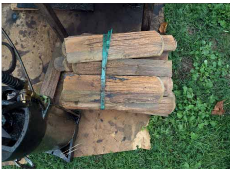
Ytterehörna kyrka. Bunt med lagnings- spån med stora delar splintved.
