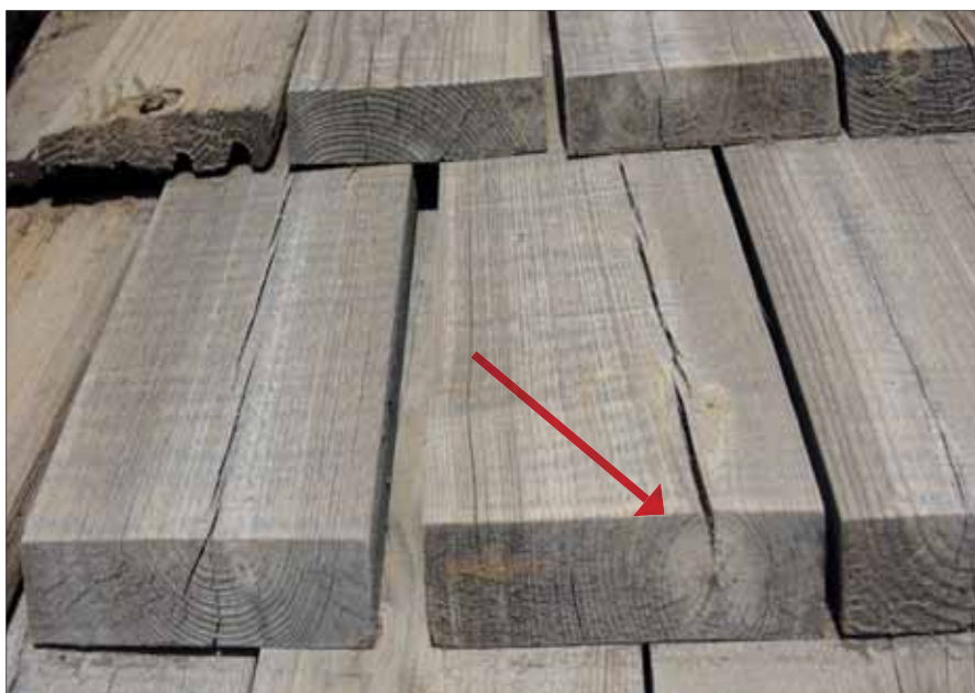
Det markerade stavspån är en så kallad märgfångare eftersom märgen finns med i spån. Aspeboda klockstapel, Västerås stift. Foto Sanna Svensson.
