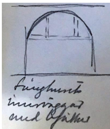
Figur 35. En liknande konstruktion med inmurade bjälkar är dokumenterad i Sala sockenkyrka, Västmanland. Dokumentation i Sveriges kyrkors arkiv, ATA.
