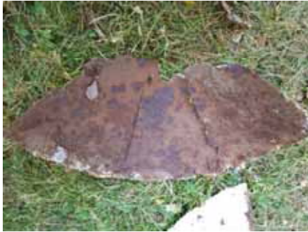
Figur 49. Lossnade plåtar sedda från baksidan. Plåtarna har legat omlott och varit fästa vid underlaget med spik.
