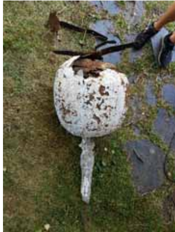
Figur 43. Ett järnsjutt går igenom konstruktionen och håller samman de olika delarna. Figur 44. Stommen av korslagda bräder uppvisar rötskador.
