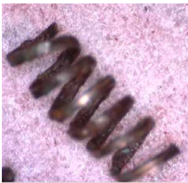
Spiral, ca.60 x förstoring. Lite kopparkorrosion synlig på insidan
