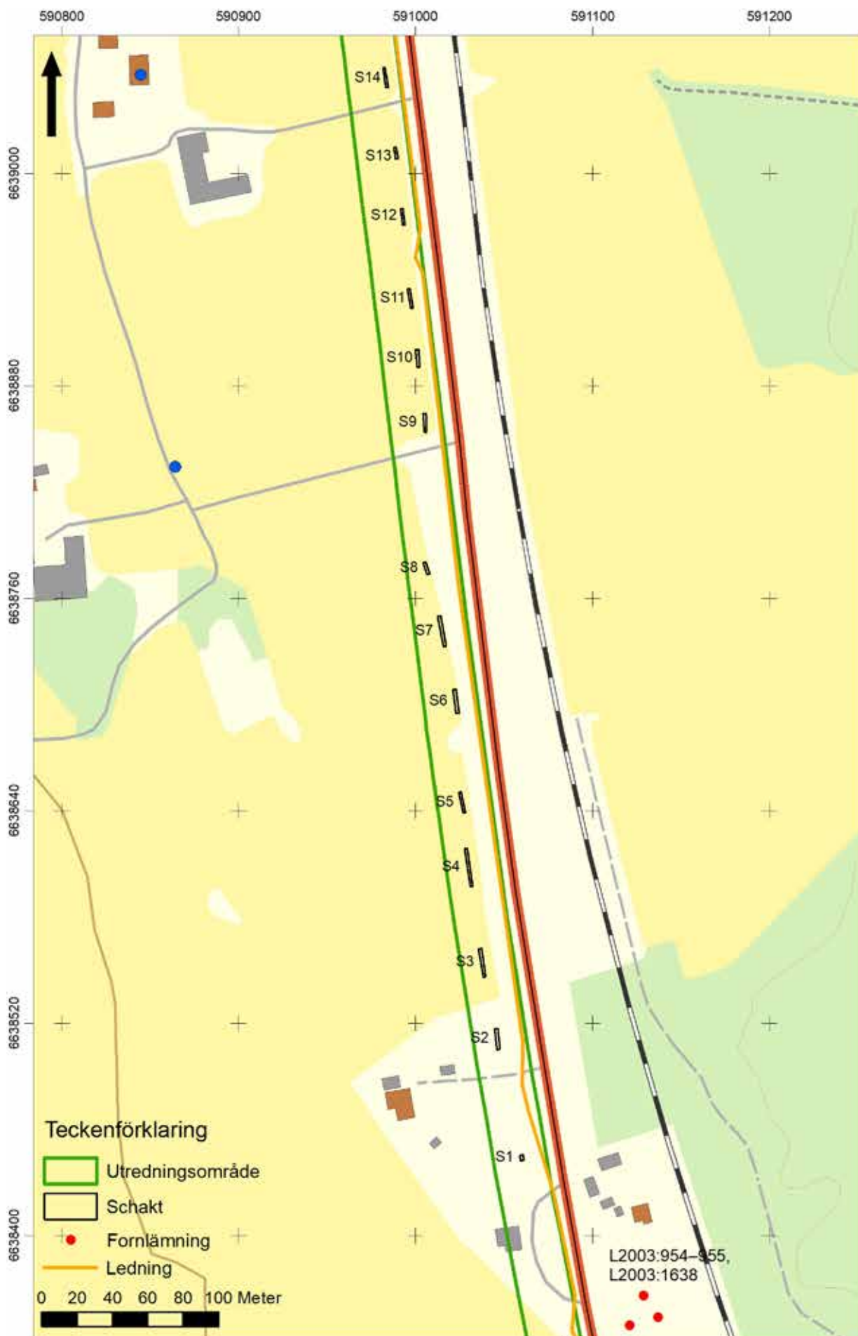
Figur 6. Schaktplan objekt 5, norr om Gulla grind. Relevanta fornlämningar är markerade med registrummer enligt KMR. Utdrag ur Fastighetskartan. Skala 1:3 000.
