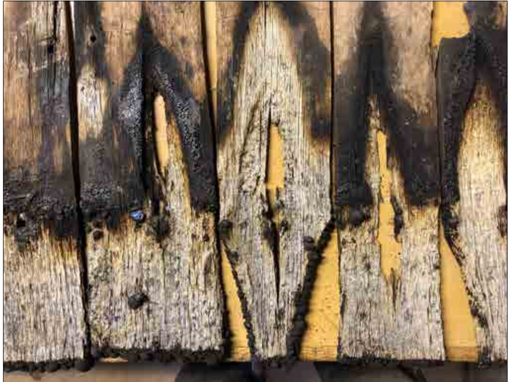
Figur 3.15. Demonterade spån med skador. Foto Daniel Eriksson.
