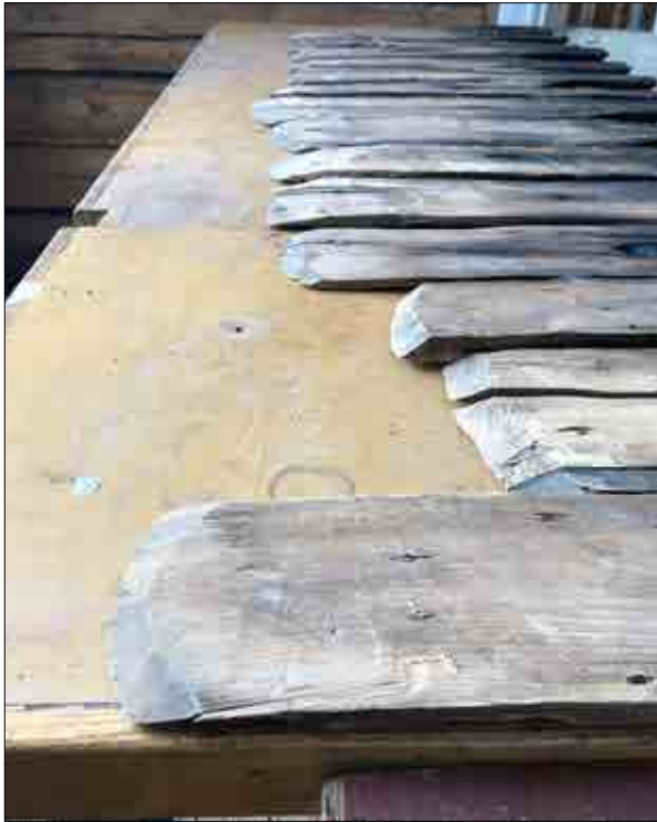
Figur 3.236. Alla spån är ändkapade på grund av att de varit för långa/tjocka. Foto Daniel Eriksson.
