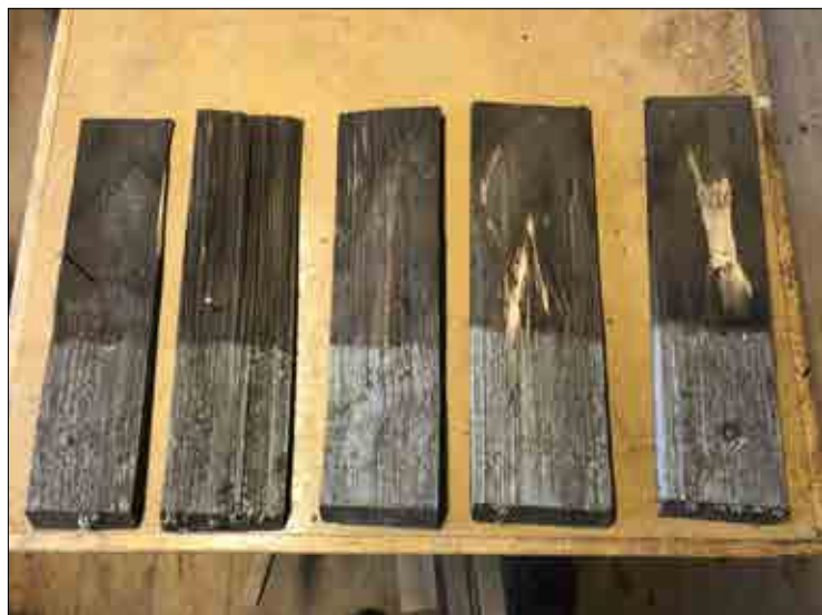
Figur 3.7. Demonterade spån i verkstaden. Spånen är lätt eroderade och verkar tjärdoppade, men vissa obehandlade ytor finns. Foto Daniel Eriksson.
