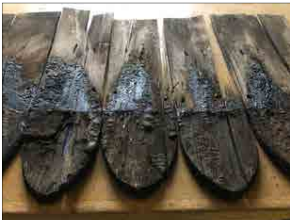
Figur 3.195. Detalj av demonterade spån som uppvisar sprickor och erosion. Foto Daniel Eriksson.
