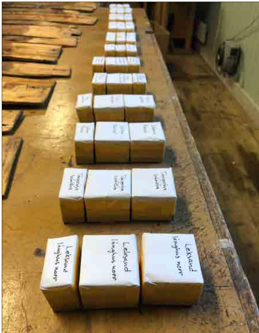
Figur 2.15. Tjärproverna packades in per spåntäckning i små paket som skickades till LTU och för tunnslipsanalys. Foto Daniel Eriksson.
