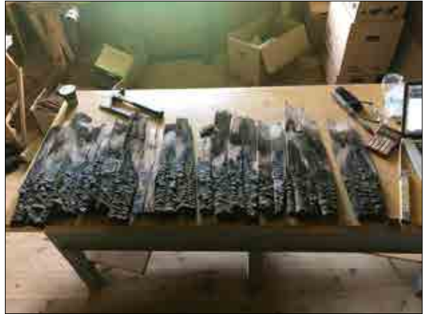
Figur 3.213. Demonterade spån i verkstaden, oöversidor. Foto Daniel Eriksson.
