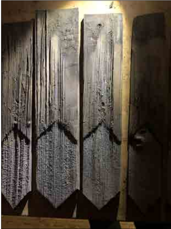
Figur 3.126. Spänens framsida uppvisar erosion, klynspår och buggspår. Foto Daniel Eriksson.
