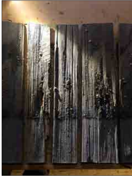
Figur 3.203. Demonterade spån har kluven framsida, justerade med såg och uppvisar erosion. Foto Daniel Eriksson.
