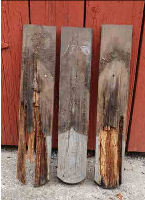
Figur 3.284. Demonterade spån från långhustaket. Foto Lisa Skanser.
