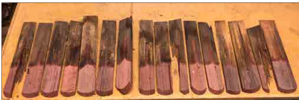
Figur 4.9. Rötskadade spån från Hammarby kyrka. Virket har blivit mörkt brunt och sprickor har uppstått. Foto Daniel Eriksson.
