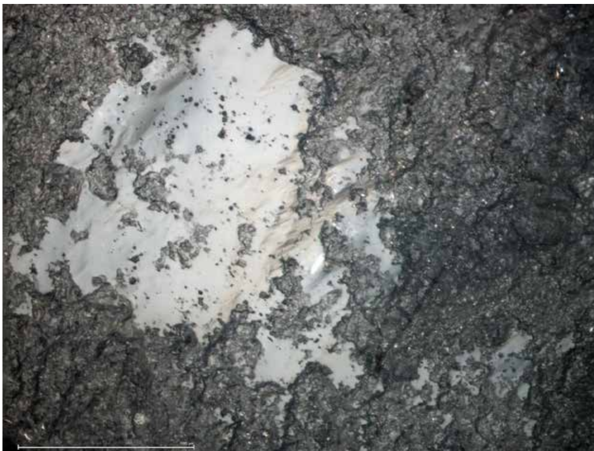
Figur 40a-c. Foton av två områden på redskapet. Båda visar samma typ av skada en slät vit klart avgränsad yta något sönderbruten och med linjära strukturer och sprickor. Foto c är förstoring av det övre området i bild b. Skalan är 100 \mu lång.
