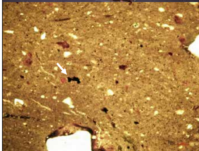
Detalj av Ts 12 Klump av pyritklor (pil). Planpolariserad.
